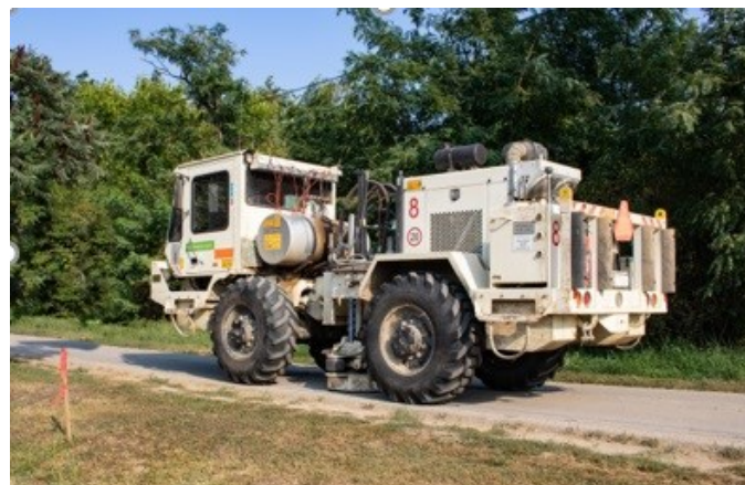
Önjáró vibrátor jármű, amely nagytömegű súly talajra helyezésével adja át rezgéseket a mélyebb rétegeknek.
